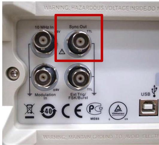
同步輸出(Synchronized Output)的 BNC 接頭
