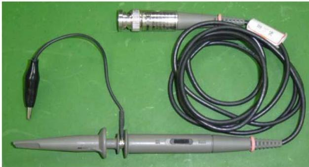
Tektronix--P2100--被動式探棒
