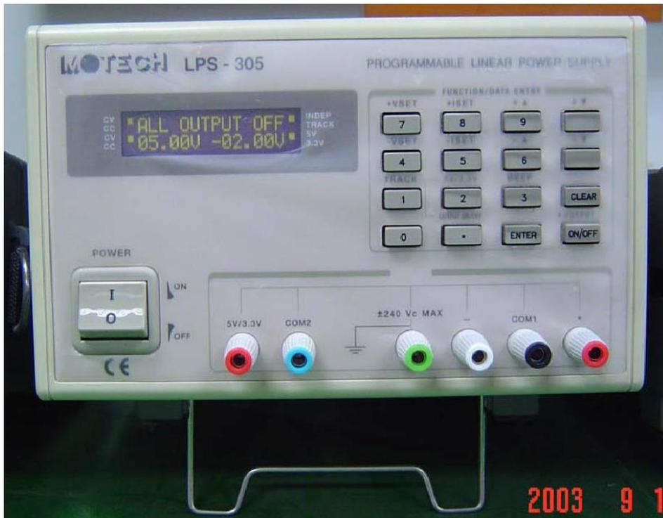
茂迪公司--LPS-305 型--直流電源供應器提供一個固定的直流電壓(當然，同時提供一個直流電流)，其功能類似一個電池，但是使用較方便且有彈性。
