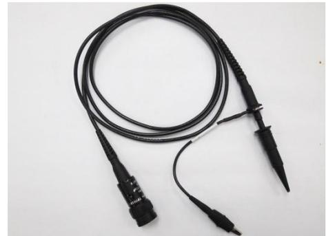
Tektronix—TPP0101--被動式探棒
