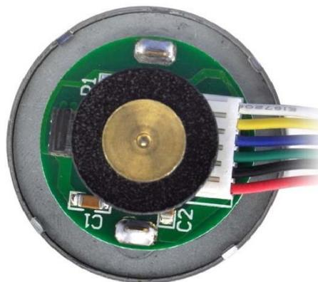
增量型的編碼器，處理兩相位霍爾感測器送出的脈波，解碼成四個相位 (Phase)，透過計數數值來計算旋轉的圈數。
